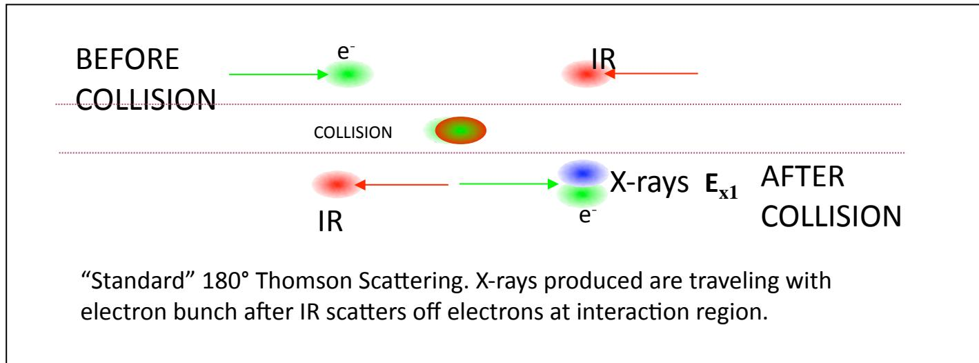
$$\ell \sim \frac{n_e \cdot n_\gamma}{\sigma_e \cdot \sigma_\gamma} \sim 2 \times 10^{43} \text{ cm}^{-2} \text{ s}^{-1}$$
