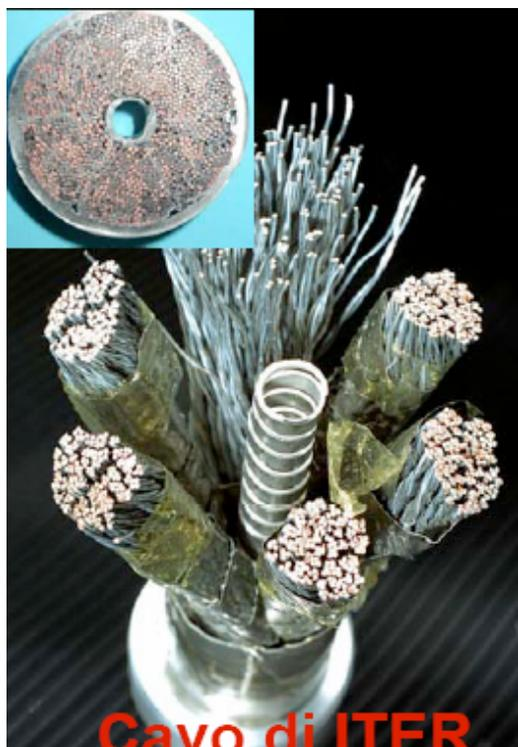
ENEA ha coordinato la realizzazione e i test di prova dei conduttori in  $Nb_3Sn$  dei prototipi dei magneti di ITER.
