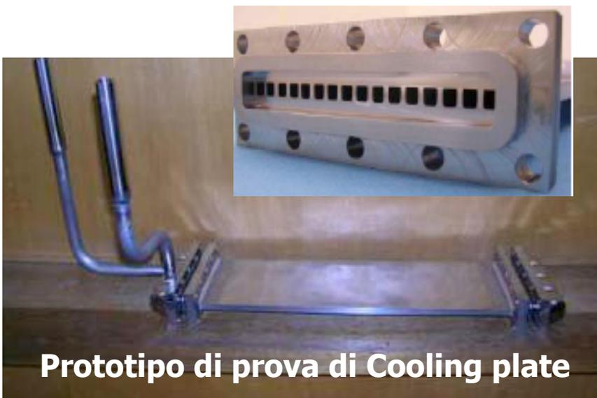
Prototipo di prova di Cooling plate
