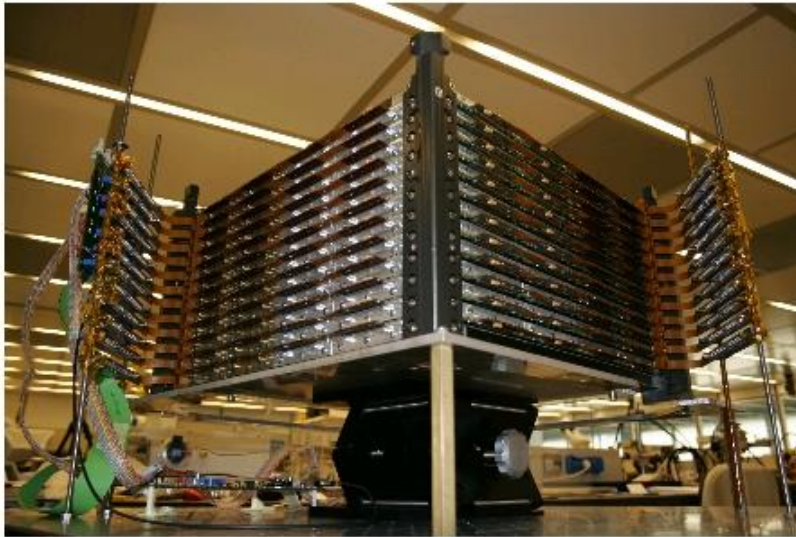
Figura 14 – Il Si-Tracker di AGILE: modello di volo completo.
