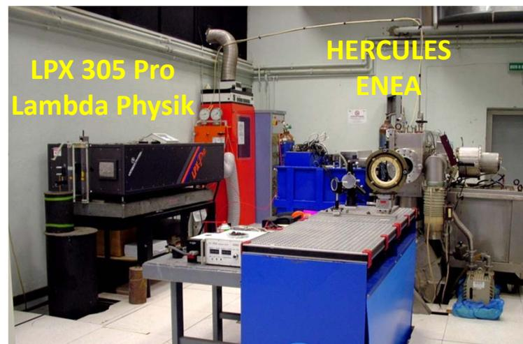
I due laser a XeCl ( $\lambda=308$  nm) utilizzati per la creazione del plasma di EGERIA
