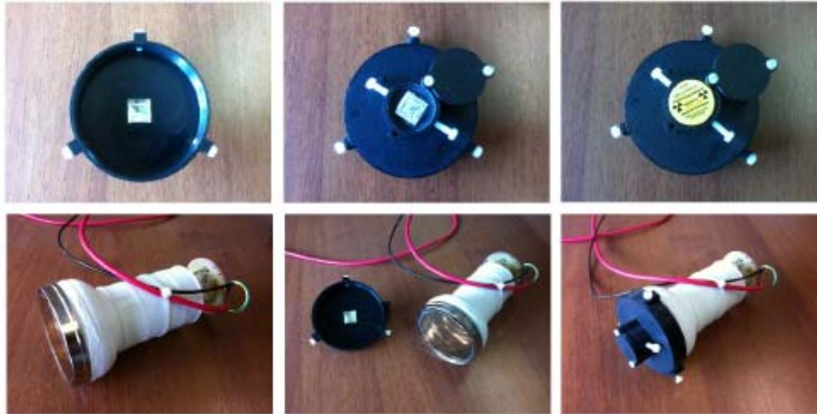
Pr:LuAG accoppiato alla finestra di un PMT Hamamatsu R11065, alloggiato assieme alla sorgente di  $^{137}\text{Cs}$  in un supporto disegnato da Milano Bicocca e realizzato con la stampante 3D di Sezione.
