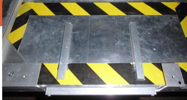
Maniglie per il trasporto ed l'assemblaggio (il peso di ogni piano è stato ridotto del 50% consentendone una facile manipolazione)
