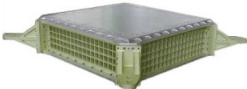
Fibre scintillatori disposte in maniera orizzontale sul piano in modo da avere una ricostruzione tridimensionale
