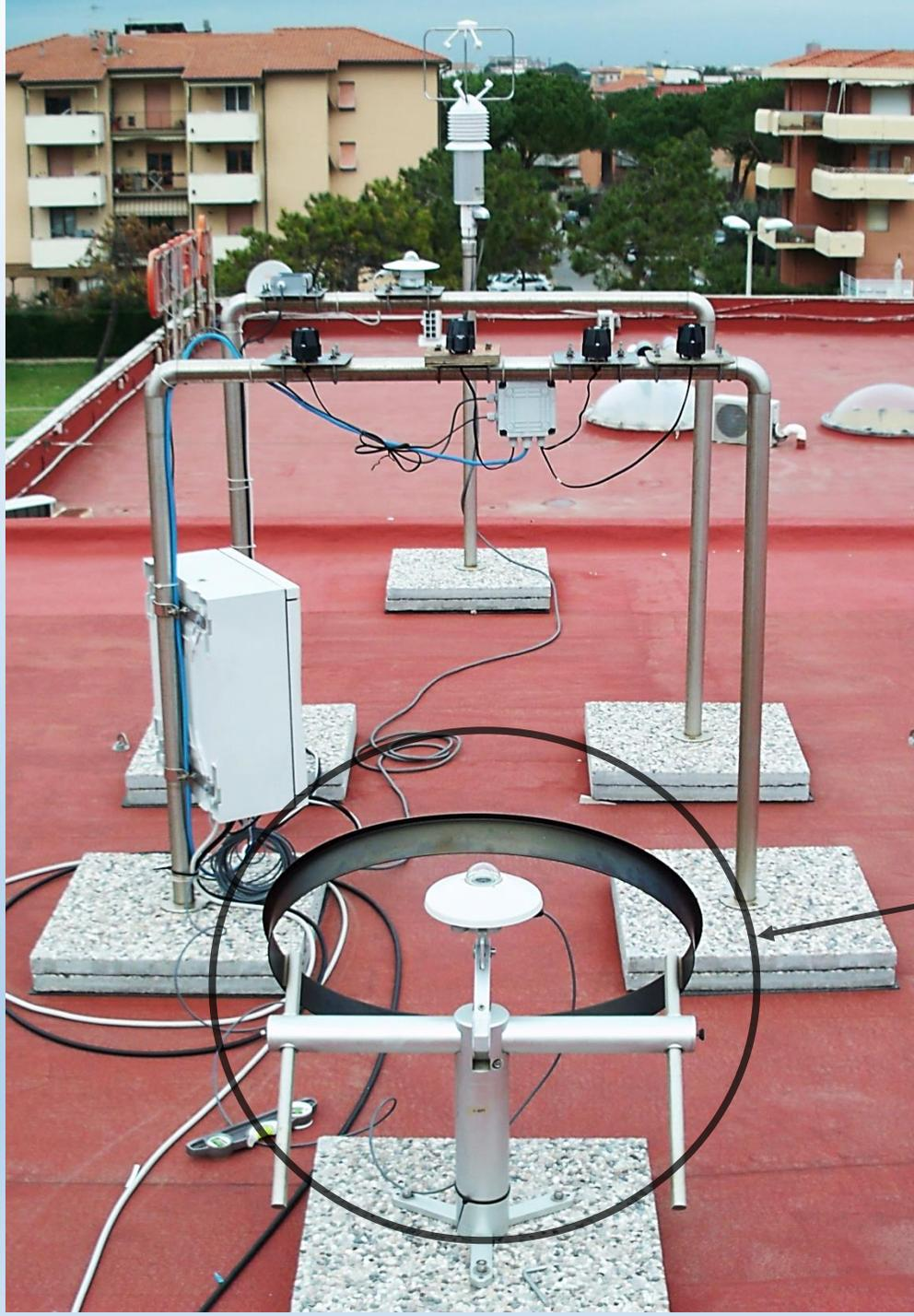
Piranometro di prima classe con Shadow Ring per la misura d'irradianza diffusa
