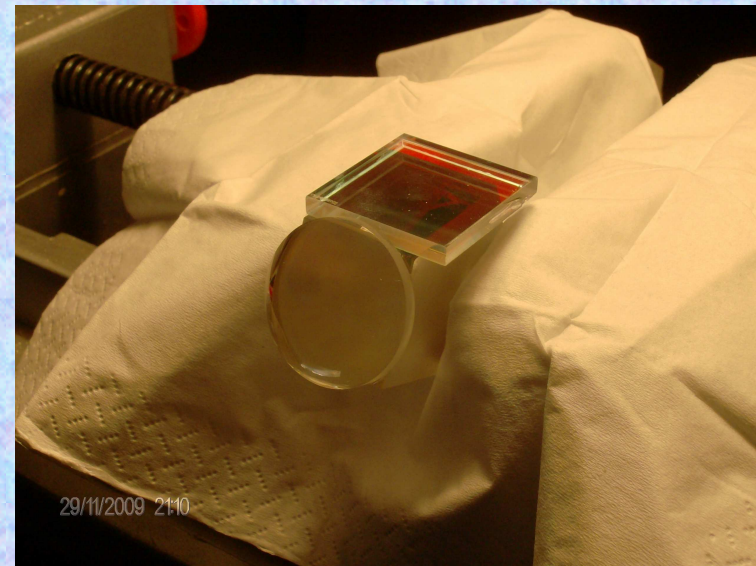
Pentaprism fused Edmund PO: 046047 (con lente piano-convessa; f=20\text{mm} )
