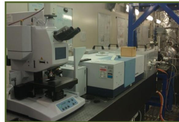
Microscopio FTIR con detector FPA, presso INFN (Frascati)
