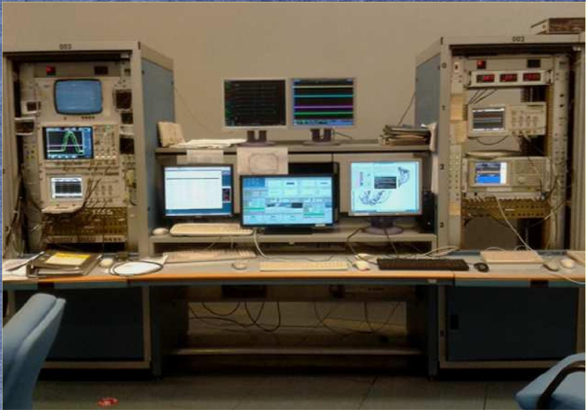
**Monitor feedback trasversari elettronici: le 2 tracce in alto sono le uscite provenienti dai kicker orizzontali e le due in basso dai kicker verticali**
