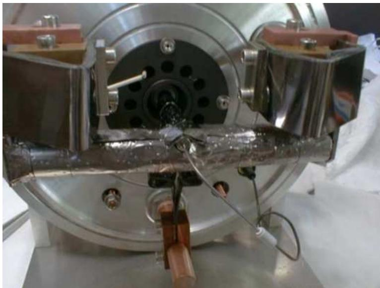
standard Isolde target
