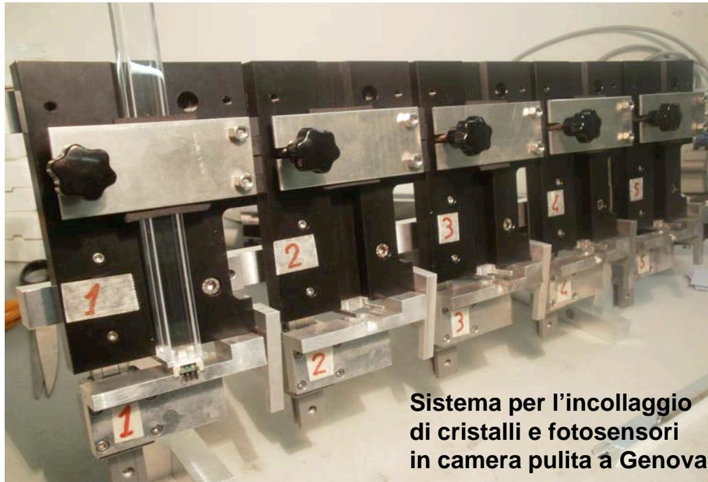
Sistema per l'incollaggio di cristalli e fotosensori in camera pulita a Genova
