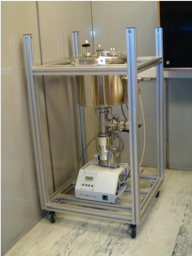
L'apparato è costituito da una camera a vuoto, entro la quale le cariche elettriche prodotte da una sorgente radioattiva (inizialmente  $^{241}\text{Am}$  e successivamente  $^{252}\text{Cf}$ ) sono raccolte e la differenza di potenziale tra due elettrodi viene misurata con un elettrometro elettronico.
