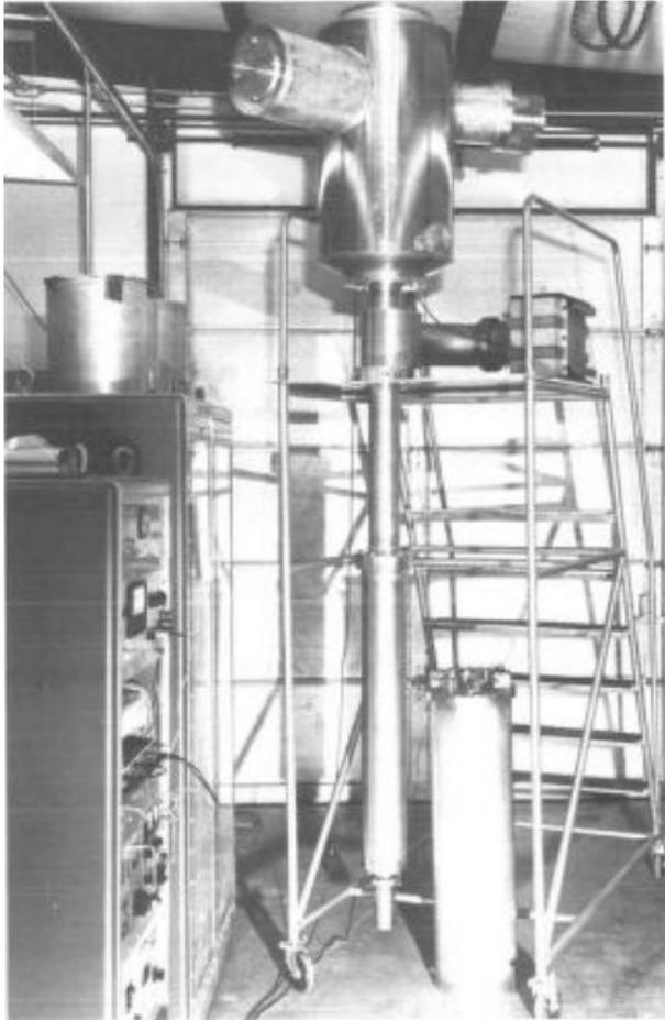
Una cella costituita da un elemento contenente  $\text{UO}_2$  in strato sottile ed in vuoto ed un elettrodo di raccolta inserita all'interno di un reattore nucleare.
