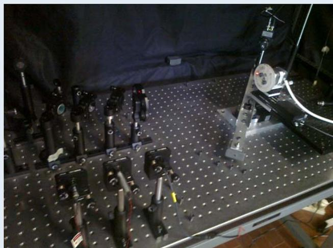
Fotometro polare a multi- $\lambda$  realizzato a Milano ( $\lambda = 635, 405, 532, 780 \text{ nm}$ )
