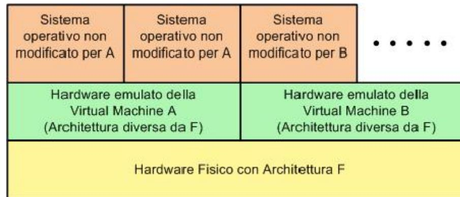
L'emulatore simula una architettura hardware diversa da quella fisica
