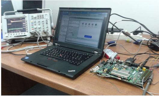
Sistema di controllo laser tramite VIRTEX5. La sequenza di trigger e' visualizzata all'oscilloscopio.
