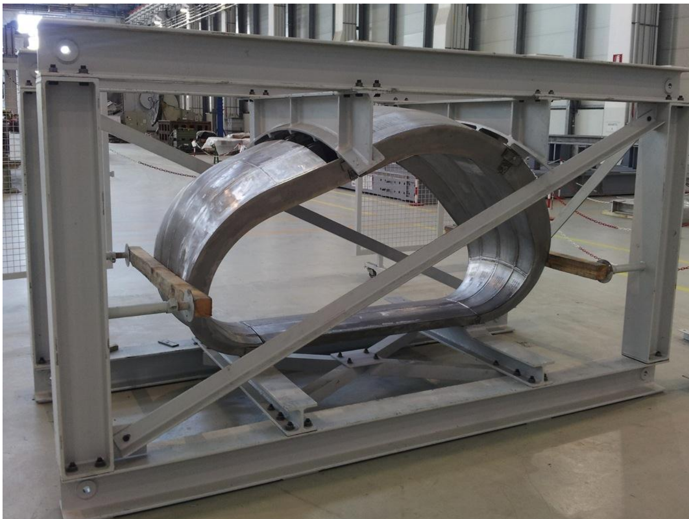
Mock up settore a scala ridotta
