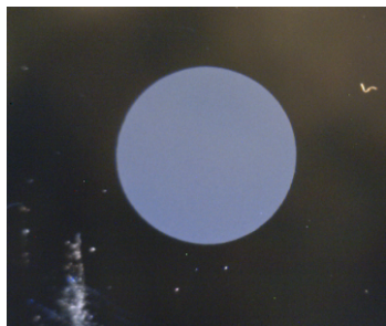
CNT su silicio area emissiva \Phi 3 mm
