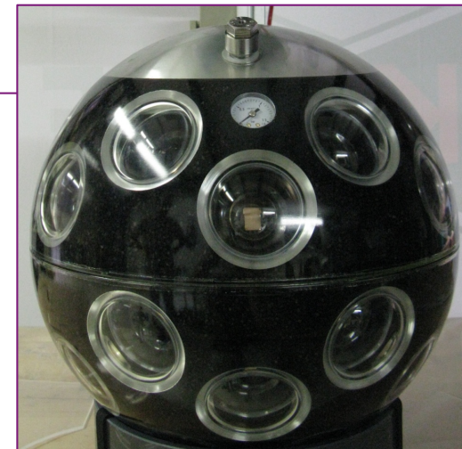
Modulo Ottico con 31 PMTs da 3” Migliore identificazione del fondo
