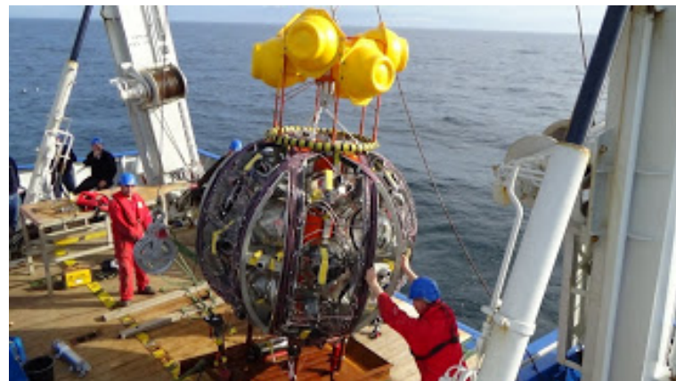
Lanciatore con stringa KM3NeT in fase di deployment
