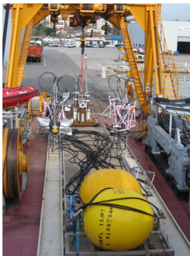
Instrumentation line di ANTARES imbarcata per il deployment
