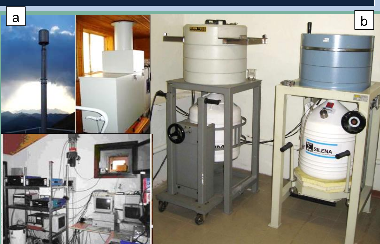
Figura 2 (a,b). a) Campionatore di PM 10 ad alto volume a Mt. Cimone. b) Rivelatori al germanio iperpuro (HPGe) al Laboratorio di Chimica e Radioattività ambientale (a sinistra, rivelatore di tipo planare; a destra, rivelatore coassiale tipo-p).
