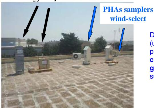
Due campionatori ad alto volume (uno con capacità "wind-select") per la rilevazione delle concentrazioni di IPA nella fase gassosa e nella fase particolato su campioni di 48-72 ore.
