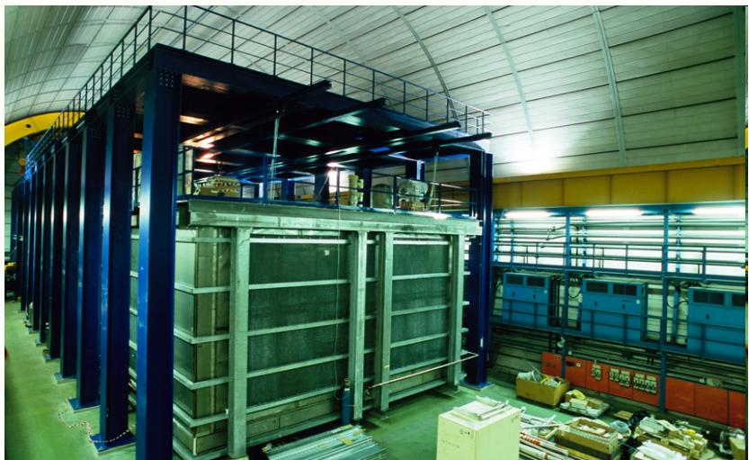
ICARUS è costituito da un grosso recipiente contenente 600 tonnellate di Argon allo stato liquido in cui sono immersi particolari rivelatori chiamati TPC (time projection chamber). Questo sistema permette una ricostruzione spaziale tridimensionale delle tracce prodotte dalle interazioni dei neutrini.
