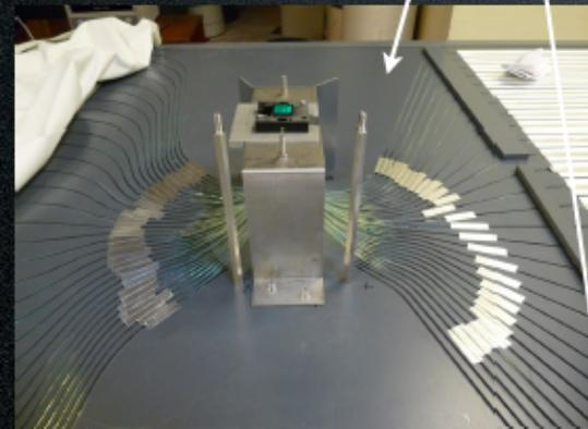
**Fibre ottiche:** 64 fibre di 4 m (2 m)
