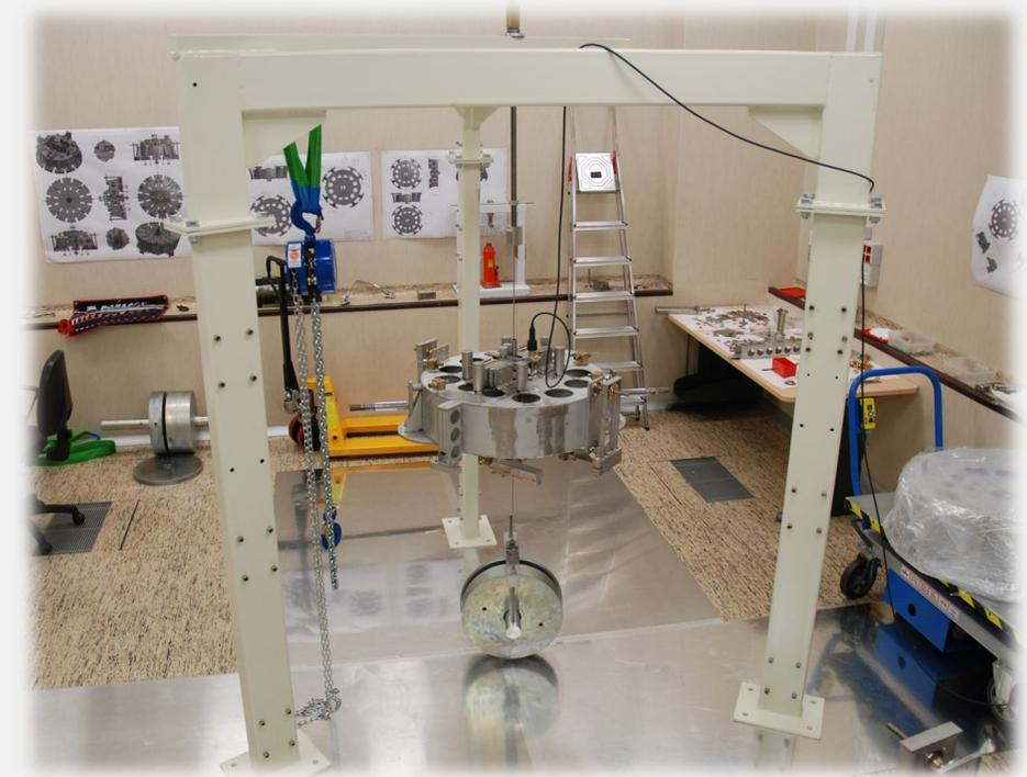
I 10 Super-attenuatori che costituiscono il cuore di Advanced VIRGO, sono formati da catene di pendoli multi-stadio ciascuno alto poco meno di 10 m e costituito da 6 filtri meccanici.
