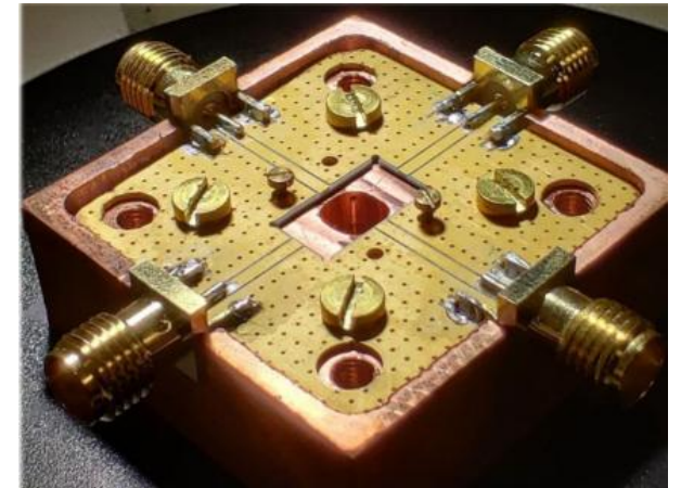
Esempio di simulazione e realizzazione in officina di portacampione a basso rumore per qubit a 8 GHz
