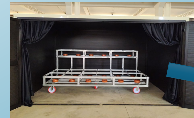
Dark box per la calibrazione dei moduli ottici
