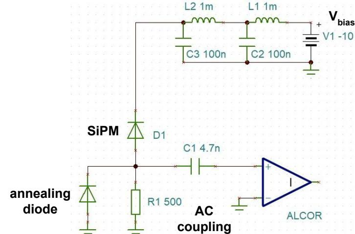
Simulazioni per vedere diversa risposta in funzione della capacità del diodo, che può caricare la linea di ingresso tra SiPM e ALCOR
