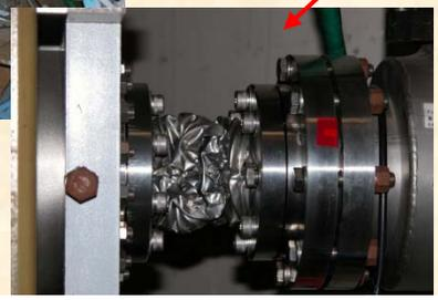
分析電磁石ベローズ破断
