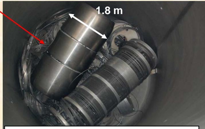
震災により加速器内部が崩壊
