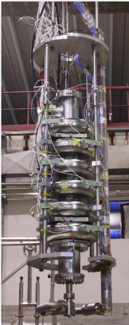
Preparazione cavità per il test
