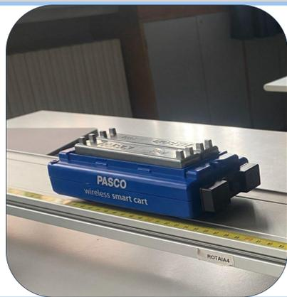
Abbiamo verificato la dinamica dei fenomeni d'urto tra carrelli dotati di **sensori** collegati via bluetooth al computer tramite il **software PASCO**.
