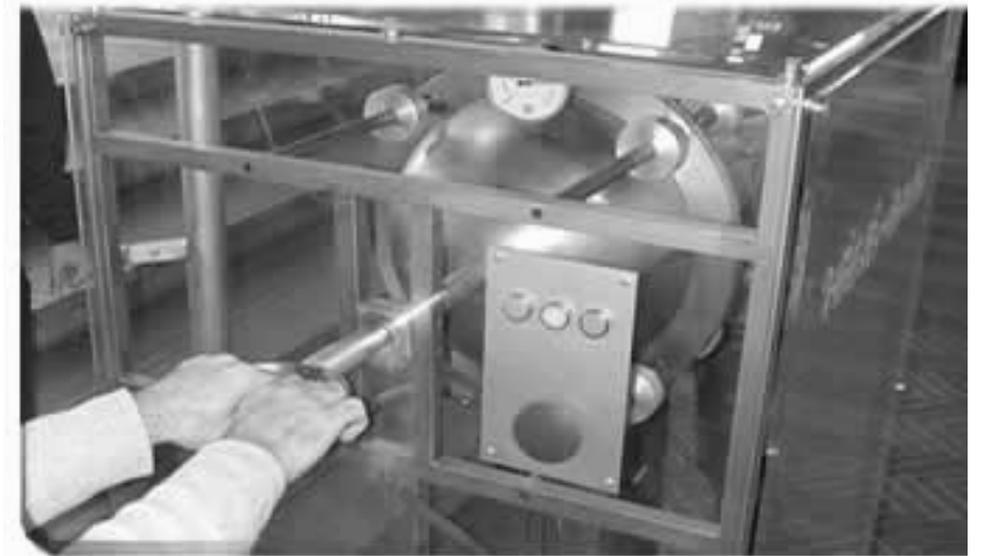
Se si deve verificare la tenuta meccanica di una flangia di un materiale particolare da impiegare in una camera da ultra alto vuoto
