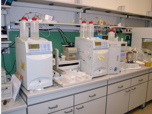
CROMATOGRAFIA IONICA Ioni inorganici secondari
