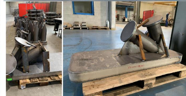
Figura 2: Puntatura masse contrappesi sinistre (SST1-22-000-01)
