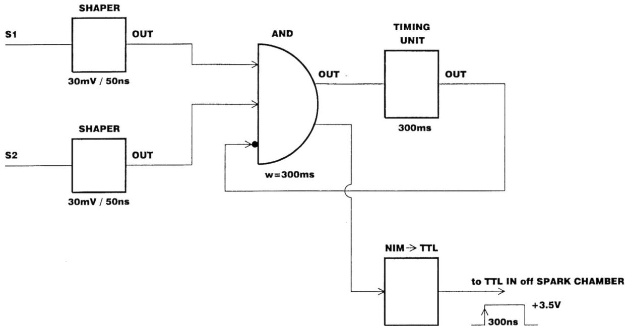
*Schema semplificato del sistema di trigger della camera a scintilla.*
