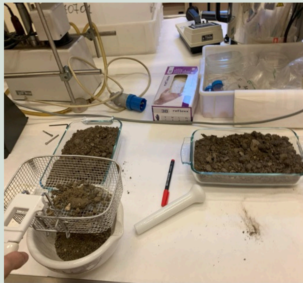
PREPARAZIONE: ESSICCAURA, FILTRAGGIO, PESTAGGIO e PESATURA
