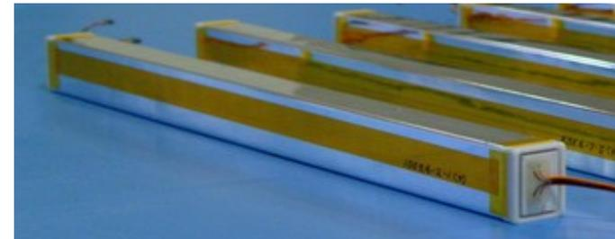
La segmentazione del calorimetro permette di misurare avere un'immagine dello sciame e.m.
