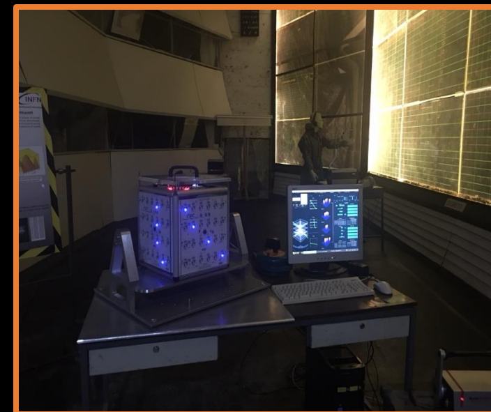
Misure di flusso dei raggi cosmici all'interno delle gallerie del Monte Soratte (Roma) https://www.academia.edu/66003600/Measurement_of_the_muon_flux_in_the_bunker_of_Monte_Soratte_with_the_CRC_detector
