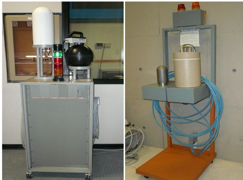
**Sistemi portatili attivi:** insieme di monitori portatili, ciascuno con caratteristiche diverse, capaci di rivelare differenti tipi di radiazioni ( $\alpha$ ,  $\beta$ ,  $\chi$ ,  $\gamma$ , neutroni) a varie energie ed *adattabili a differenti situazioni operative* (misure ambiente, su superfici, misure a distanza o a contatto, ecc): geiger mueller, camere a ionizzazione, contatori proporzionali, Scintillatori, ecc.
