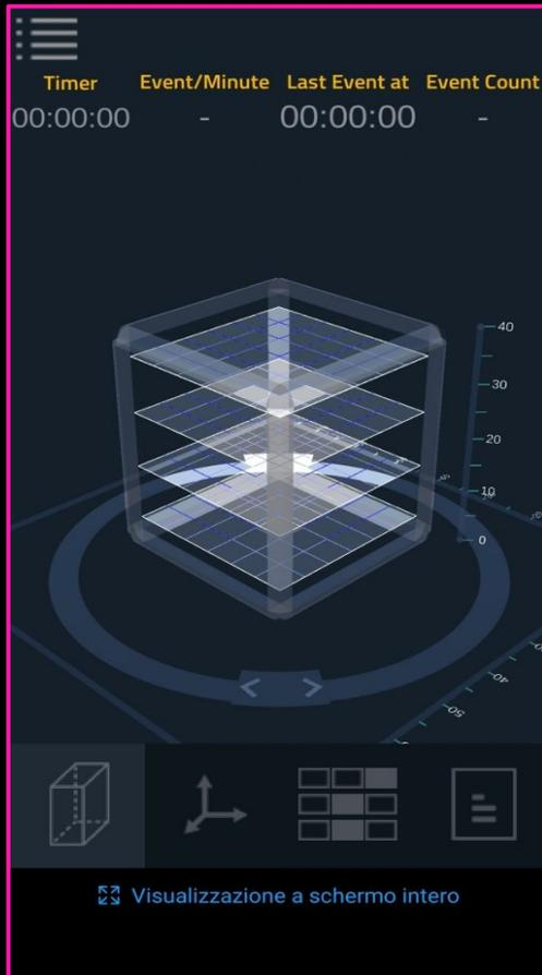
Il rivelatore è un cubo di lato 30cm, costituito da quattro moduli distanziati tra loro di 7 cm. Ogni modulo è costituito da 2 piani, ciascuno costituito da 6 bacchette scintillanti sovrapposte e posizionate ortogonalmente tra loro per consentire una lettura bidimensionale dei nostri dati
