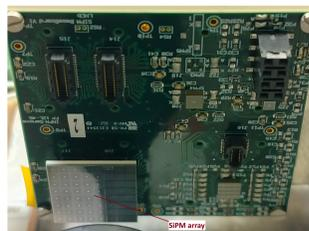
Array di SiPM su un PCB di alloggiamento.
