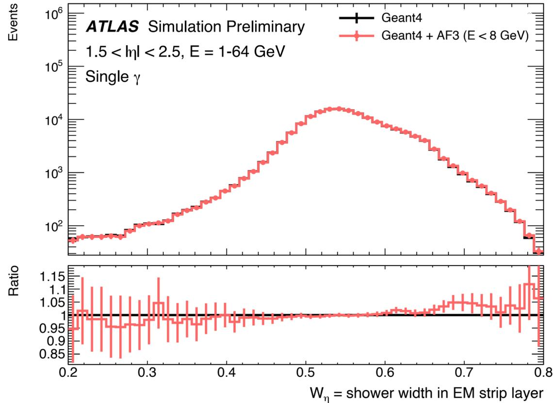
Approccio ibrido = uso di FastCaloSim o FastCaloGAN in base a tipo di particella, energia ed  $\eta$  come da diapositiva 5 (invece di impiegare solo FastCaloSim o solo FastCaloGAN)
