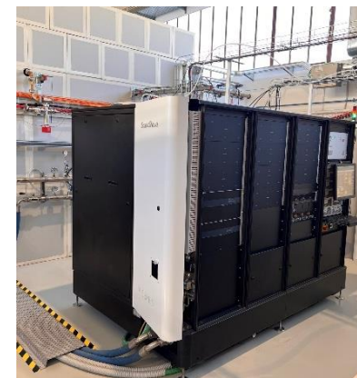
50 MW RF Source
