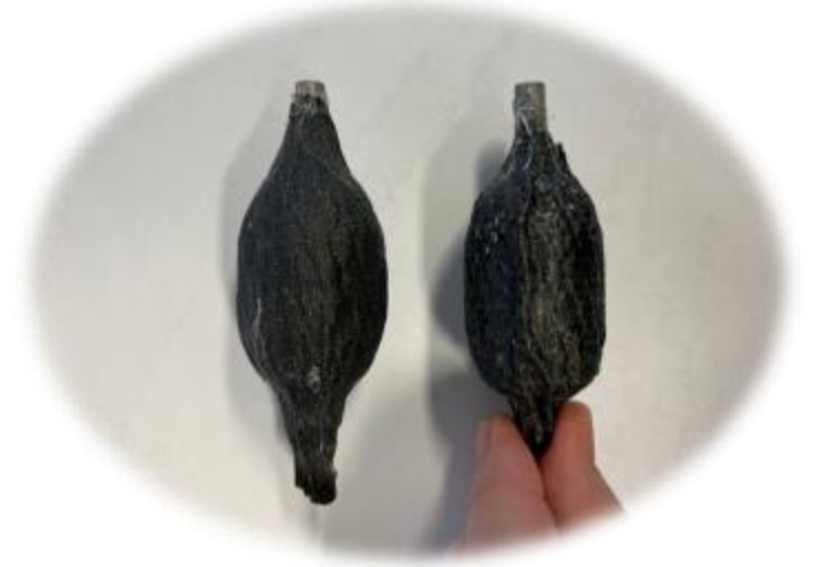
Layer esterno di fibra di carbonio
