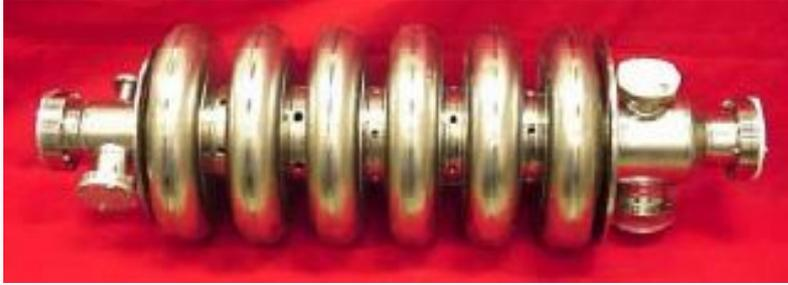
Cavità risonanti a radio frequenza (**400 MHz**)
