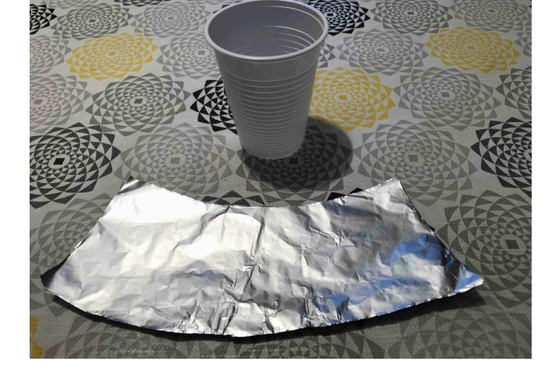
• Costruiamo un conduttore sagomato a "bandiera", ci permetterà di caricare il condensatore.
