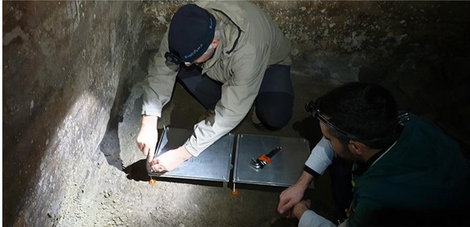
Un gruppo di ricercatori e ricercatrici dell'Università di Napoli Federico II e dell'INFN, in collaborazione con l'Università di Nagoya, ha utilizzato la **radiografia muonica** per ispezionare la presenza di possibili cavità nel sottosuolo del rione Sanità di Napoli e ha individuato la presenza di una camera funeraria sotterranea definendone la posizione tridimensionale.
