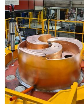
**07-02-2024** Procedura di verifica compatibilità meccanica del liner inferiore con il ferro del polo inferiore -> **rilevata interferenza meccanica**
