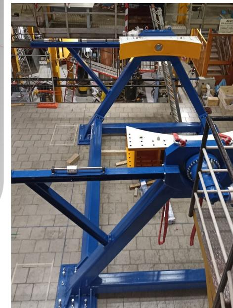
Necessario lo smontaggio del ribaltatore del polo superiore al fine di permettere la spinatura radiale degli anelli inferiore e superiore.
