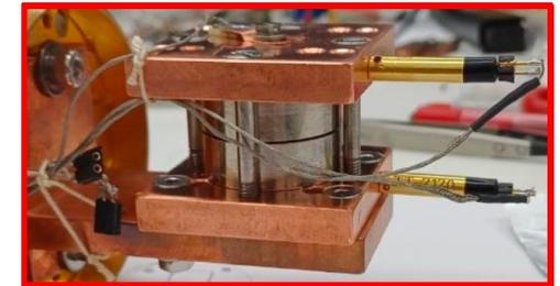
Figura 4. Configurazione del dispositivo per la misura del gradiente termico per la stima della temperatura efficace del campione di silicio. Immagine del dispositivo assemblato (basso a destra).
